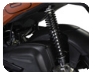
Pojedynczy amortyzator w wersji dwusuwowej
