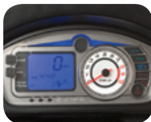
Wielofunkcyjny wyświetlacz elektroniczny z analogowym obrotomierzem
