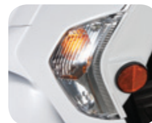
Kierunkowskaz zespolony wraz ze światłem pozycyjnym
